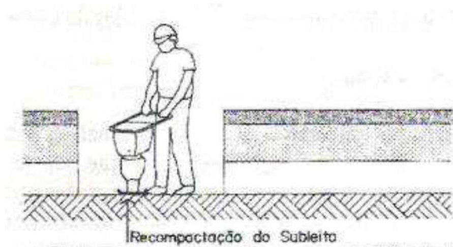
Figura 6: Readequação do subleito.
