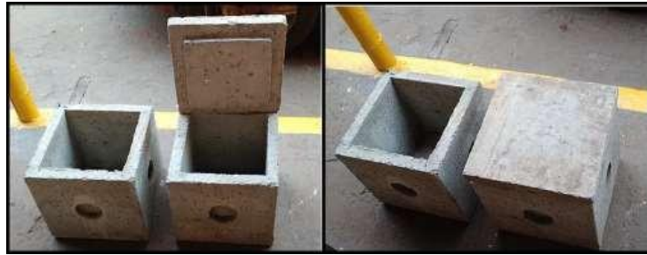
Figura 19: Caixa de passagem
