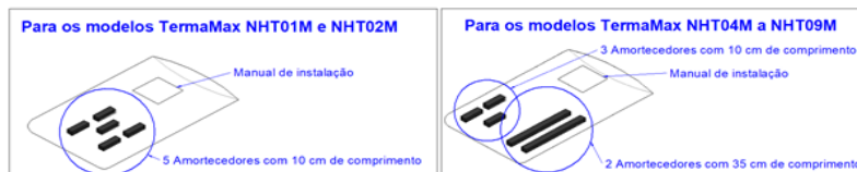
Fig. 3 – Identificação do conjunto de calços de amortecimento
